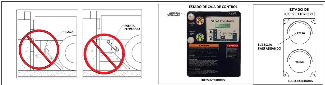
FIGURA AL—ESTADO DE FALLA
