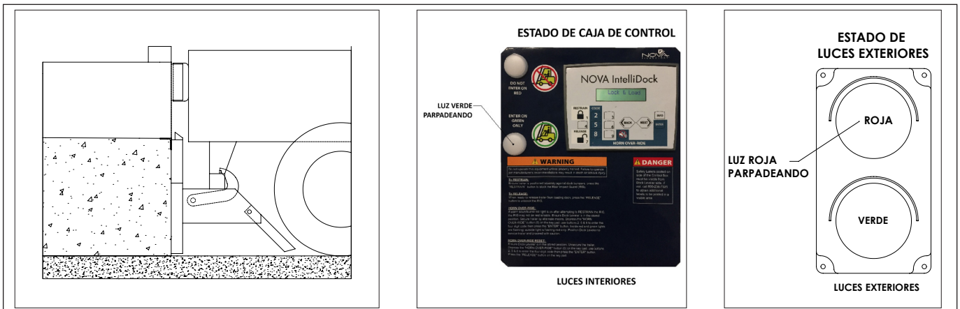
FIGURA AJ—BLOQUEO DEL RETENEDOR
