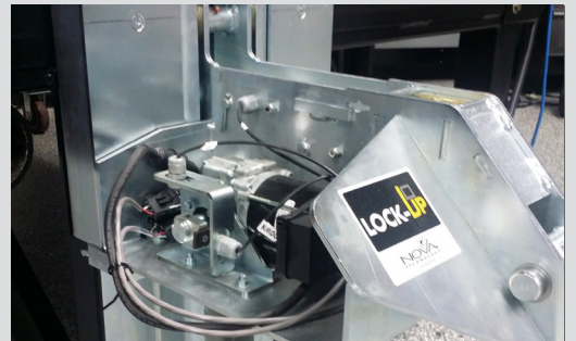
Sensores de proximidad magnéticos sellados con motor de engranajes de transmisión directa.
