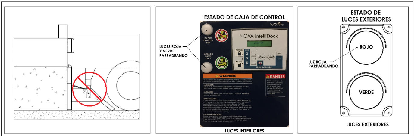
FIGURA AI—ESTADO DE ANULACIÓN DE BOCINA
