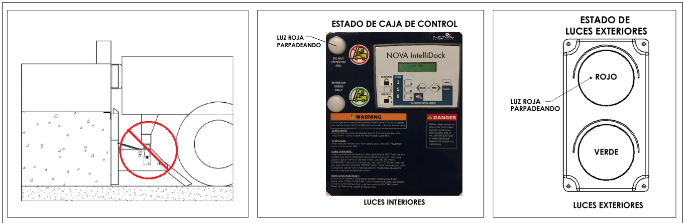
FIGURA AH—ESTADO DE FALLO
